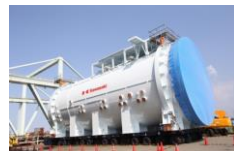
ボーイング787前部胴体用複合材硬化炉(播磨町)
